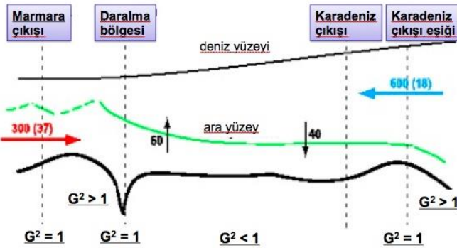
Şekil 28. İstanbul Boğazı’nın iki tabakalı akımlarını ve hidrolik kontrolün rolünü gösteren şema.
